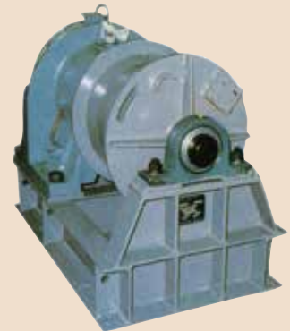
台車けん引用単胴ウインチ 能力:5,000kgf スピード:5m/min
