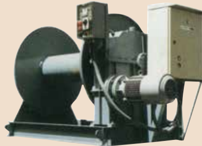
ケブラーロープ巻取ウインチ 能力:200kgf スピード:12~60m/min ケブラーロープ収容量:4,000m インバータ制御
