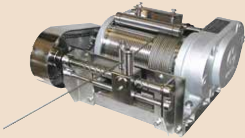
火力発電所取水口クリーニング用ウインチ ステンレス製ボディ、トラバーサー・ワイヤ押さえ装置付 能力:250kgf スピード:0.23~3.06m/min
